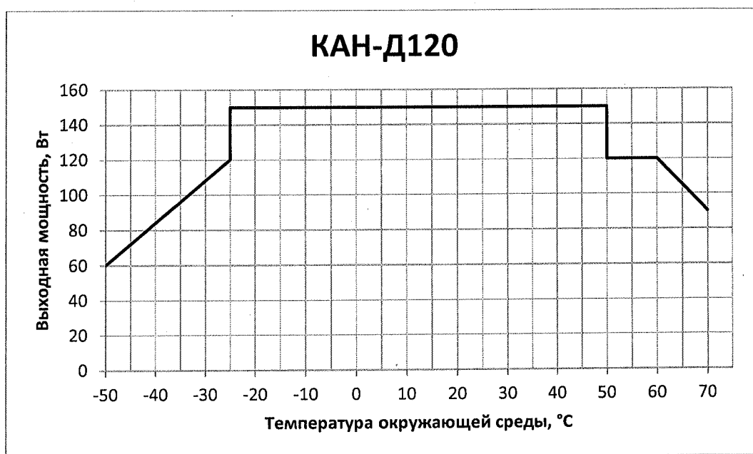
Рисунок Г.2 — График зависимости выходной мощности модуля от температуры окружающей среды для модулей КАН-Д120
