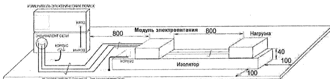
Рисунок 10 - Пример расположения модуля электропитания, измерительной аппаратуры и вспомогательного оборудования при измерении напряжения радиопомех в соответствии со схемой, приведенной на рисунке 9.
